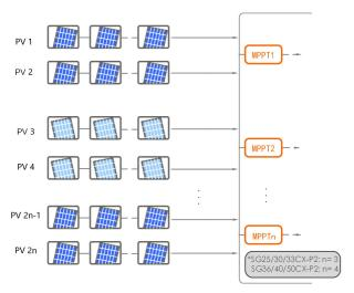
figure 5-4 PV Input Configuratioon
